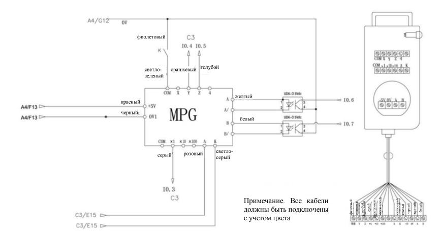
FSG60220NC Электрическая схема **C4** Подключение MPG
