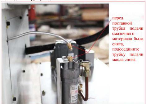
После запуска насоса автоматической смазки, масло будет подано в каждую точку смазки. Расход масла отрегулирован перед поставкой.
