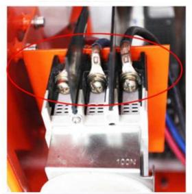
заземляющий кабель источника питания должен подключаться к каждой из этих клемм
