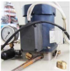
Перед запуском станка сначала запустите гидравлическую станцию. Через 20 минут смазочное масло покроет все направляющие, после чего можно запускать станок.
