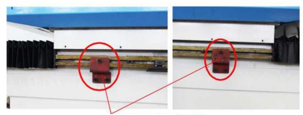
фиксирующая скоба рабочего стола
