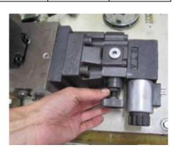
Поверните ручку регулировки давления и посмотрите на манометр, установите давление в диапазоне 2,5-3,0 МПа (25-30 кг/см²).
