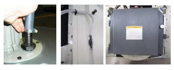
Очищайте бак и заменяйте охлаждающую жидкость по мере необходимости (охлаждающую жидкость следует заменять не реже одного раза в три месяца)
