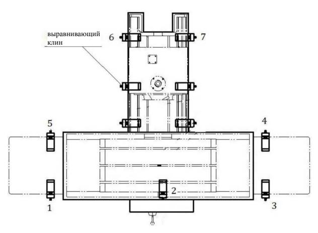
Установите микрометр вблизи задней части скользящей направляющей. Установите другой микрометр в центральной части рабочего стола.
